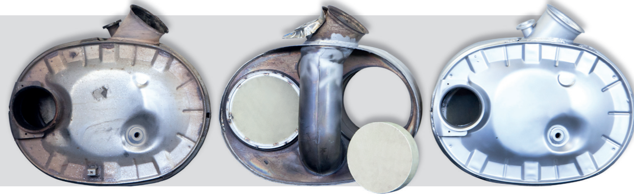
Příklad opravy katalyzátoru VOLVO FH1FM
